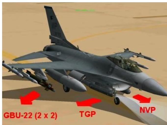
Avant toute utilisation du Targeting Pod, il faut absolument lui apporter du courant, au moyen de 2 switches situés sur la console droite, sur le SNSR Panel, juste sur le côté du manche. Donc, mettez les sur la position LEFT HDPT et RIGHT HDPT respectivement. Après quelques instants, l'inscription « NOT TIMED OUT » sur la page TGP sera remplacée par une image Infra-Rouge.
