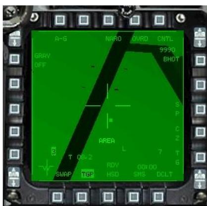
Après avoir choisi sa cible, on fait une 2<sup>ème</sup> fois TMS Up. AREA est remplacé par POINT. La cible est verrouillée.
