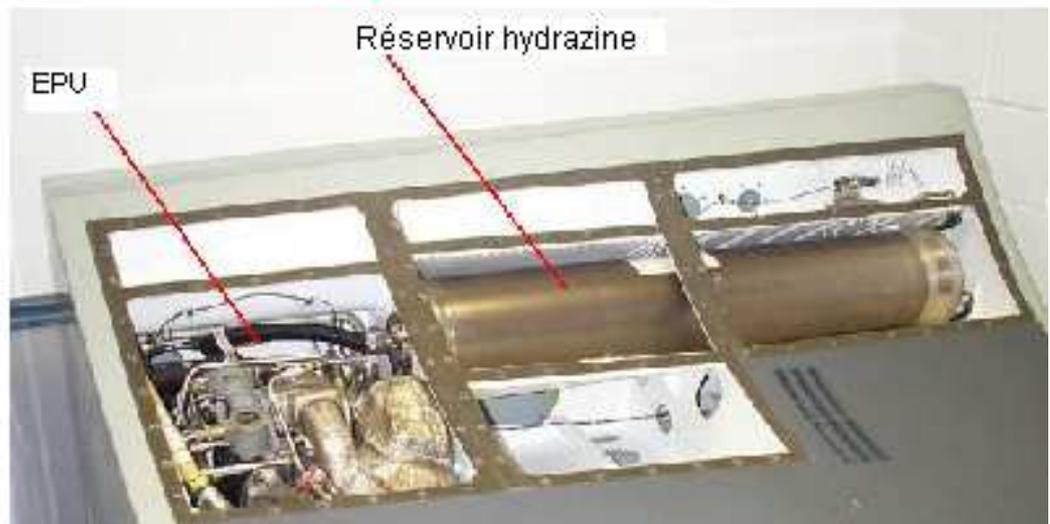
L'EPU est un autonome (figure FO-9) qui fournit simultanément de la pression hydraulique au système A et de l'énergie électrique d'urgence. L'EPU s'active automatiquement quand les 2 générateurs principal et de secours lâchent ou quand la pression des 2 systèmes hydrauliques passe en-dessous de 1000 psi. L'EPU peut être utilisé manuellement quelque soit les situations de panne.
