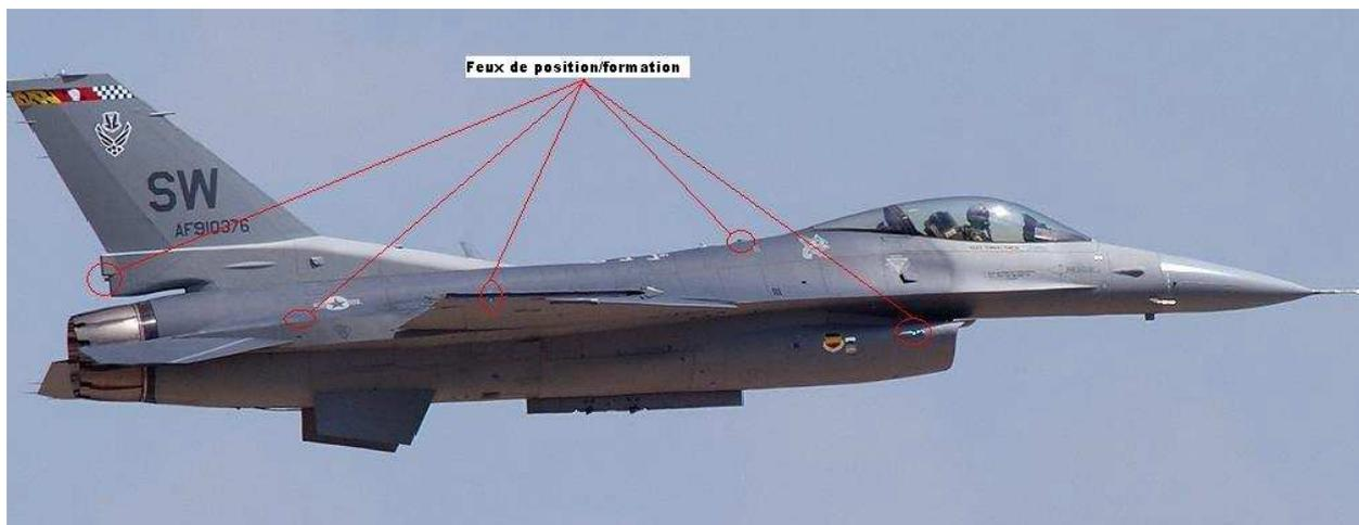
Ce sont les feux qui sont utilisés lorsqu'on vole de nuit, ou par mauvais temps histoire d'être plus sûr d'être vu. Trois feux: blanc vers l'arrière, rouge à gauche et vert à droite. Leur disposition précise ainsi que les angles couverts servent aux autres avions à évaluer la trajectoire d'un autre appareil de nuit. Il est important de confirmer rapidement si le trafic en vue s'éloigne ou se rapproche.
