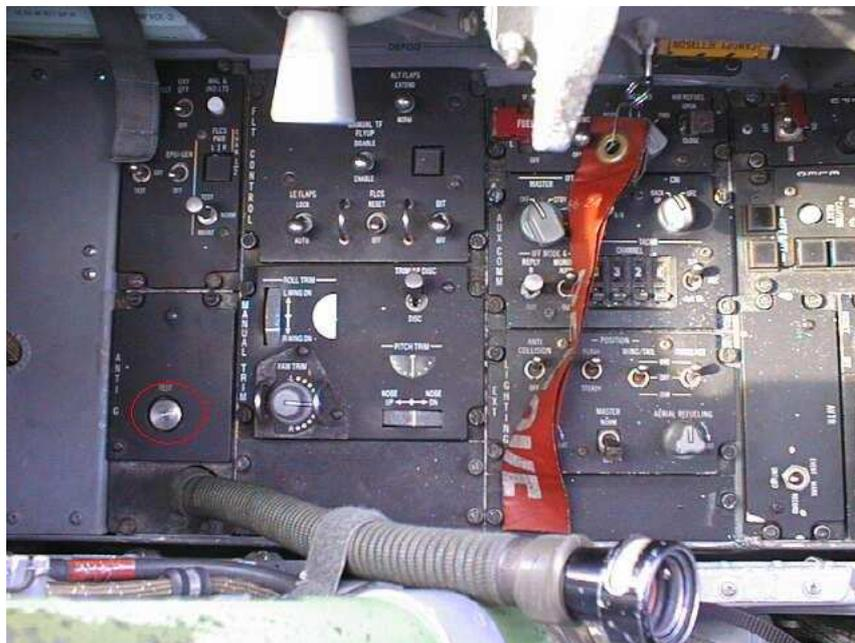
Le connecteur du pantalon anti-G et le bouton TEST sont situés complètement à l'arrière sur la console gauche. L'ECS délivre de l'air bleed frais au pantalon anti-G. Le débit d'air est proportionnel aux G encaissés. Si une coupure de l'ECS survient, la protection du pantalon anti-G n'est plus disponible.
