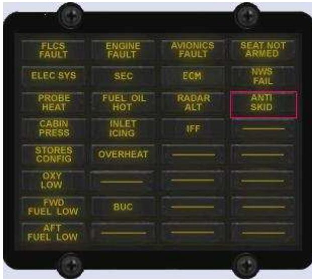
Le voyant d'alerte ANTI-SKID (figure FO-15), situé sur le panneau de voyants d'alerte, s'allume quand un dysfonctionnement survient avec le bouton ANTI-SKID sur ANTI-SKID. Il s'allume également quand la poignée LG est abaissée et que le bouton est sur OFF.
