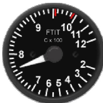
L'indicateur de température d'entrée turbine FTIT (figure 1-8) affiche une FTIT moyenne en degrés C. L'instrument est gradué de 200° à 1200°C par incréments de 100°C. L'indicateur est alimenté par le battery bus n°1.
