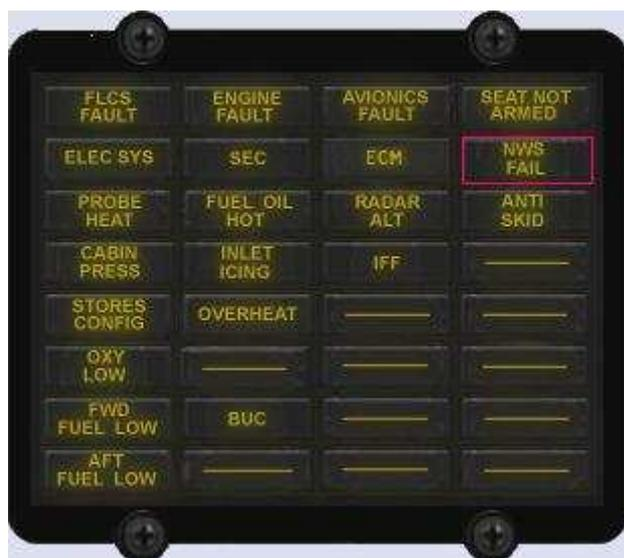
Le voyant d'alerte NWS FAIL est situé sur le panneau de voyant d'alerte (figure FO-15). Le voyant d'alerte NWS FAIL s'allume quand le NLG est verrouillée bas et qu'une défaillance dans le système NWS a causé une coupure d'alimentation électrique.
