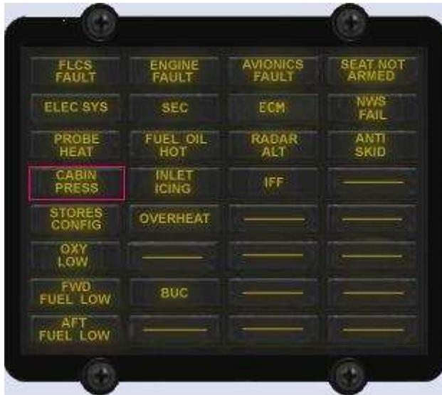
Le voyant d'alerte CABIN PRESS est situé sur le panneau d'alerte. Le voyant s'allume quand l'altitude pression cockpit est supérieure à 27 000 ft.
