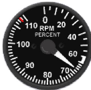
L'indicateur rpm (figure 1-8) est un affichage à aiguille et le signal rpm est fourni par l'alternateur moteur. Les rpm sont exprimés en pourcentage de 0 à 100. L'indicateur est alimenté par le battery bus n°1.
