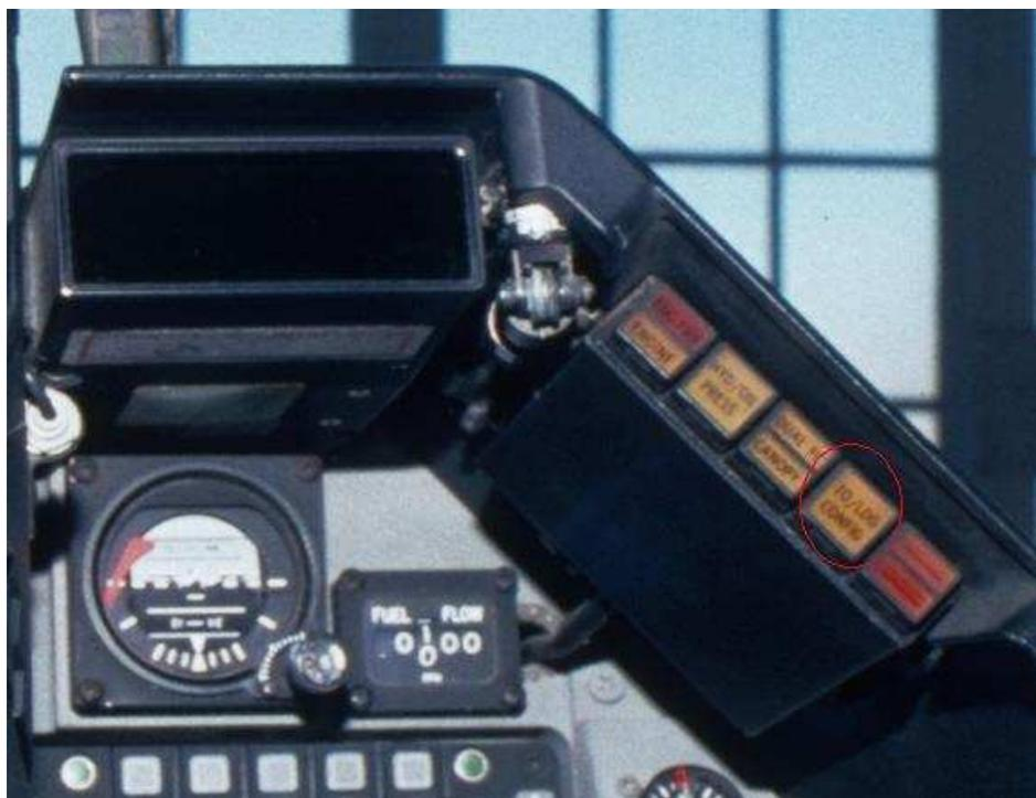
Le voyant d'alerte TO/LDG CONFIG, situé sur la casquette du tableau de bord, s'allume en vol quand l'altitude pression est inférieure à 10 000 ft, que la vitesse-air est inférieure à 170 kt, que le taux de descente est supérieur à 250 ft/mn et que l'une des conditions suivantes existe :
