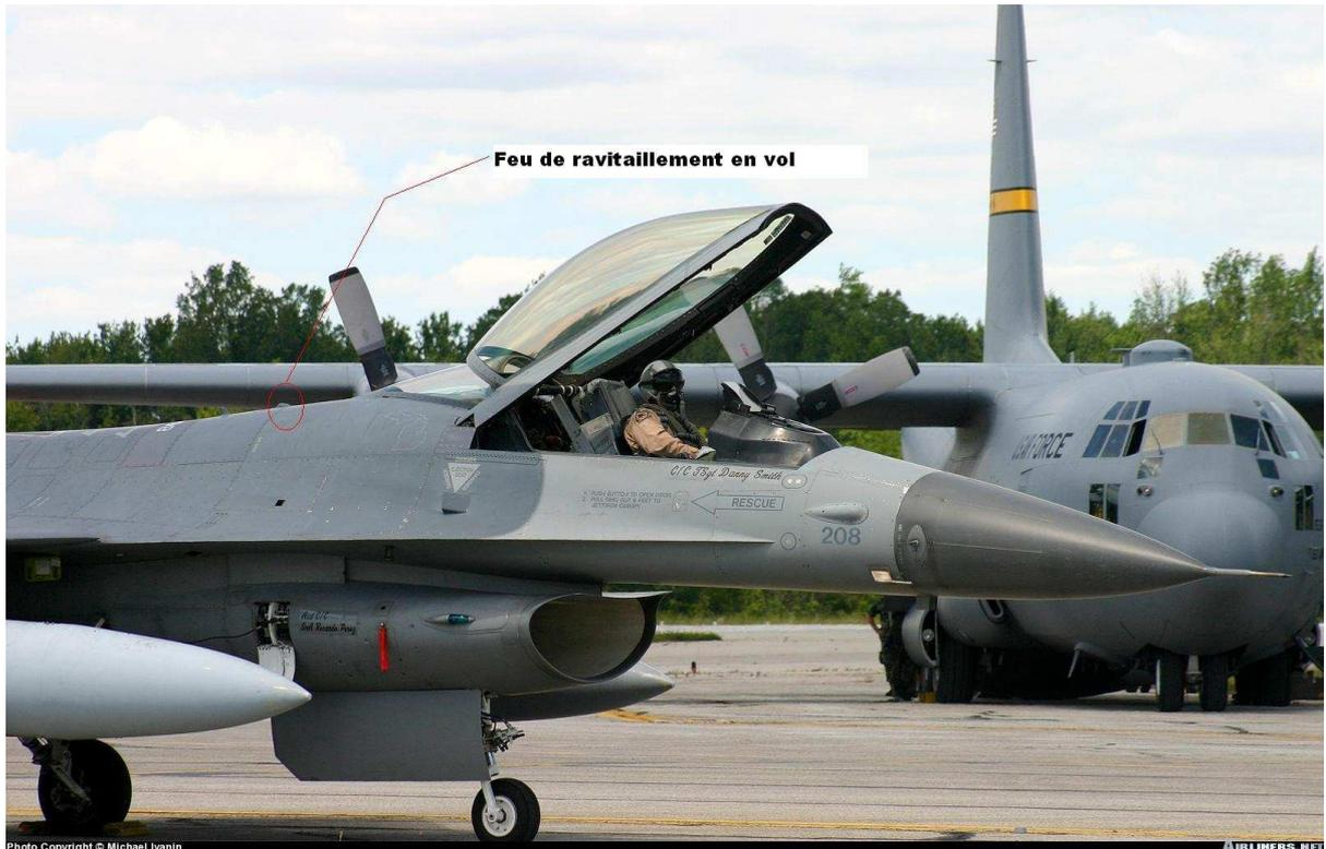
Le phare AR partage l'emplacement avec le feu de formation de fuselage. Le feu est dirigé vers l'arrière pour éclairer le réceptacle, le fuselage, l'aile et l'empennage. La trappe AR comprend des feux noyés de chaque côté de la trappe. Ces voyants sont activés quand le bouton AIR REFUEL est sur OPEN.
