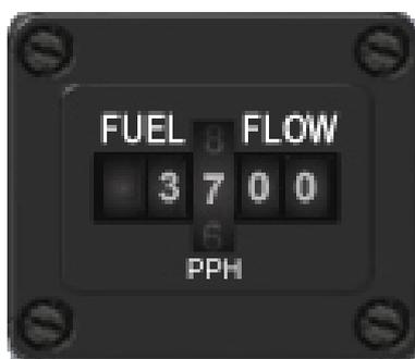
L'indicateur de débit carburant FF (figure 1-8) est un instrument digital qui affiche le débit total au moteur, incluant la PC en pouces/h. L'instrument est gradué de 0-80 000 pouces/h et est alimenté par l'emergency ac bus n°1.
