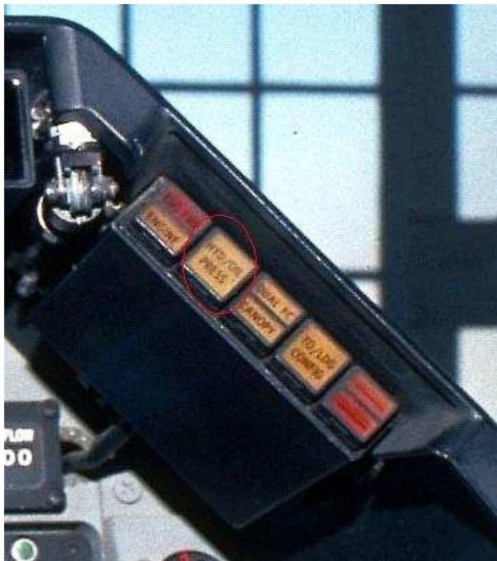
Un voyant d'alerte HYD/OIL PRESS, situé sur la casquette du tableau de bord, s'allume quand le système hydraulique A ou B passe en-dessous de 1000 psi. Le voyant d'alerte s'allume également quand en fonction de la pression d'huile moteur. (Voir INSTRUMENTS MOTEUR dans cette section) Le voyant est alimenté par le bus batterie.
