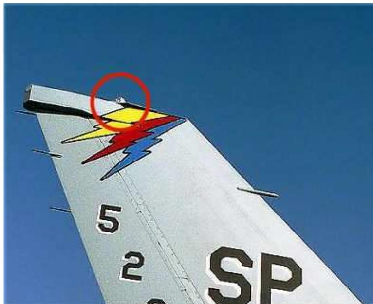
Ils sont blancs et clignotent. Appellation usuelle : "strobe lights" ou "rotating strobe lights". Ces feux permettent d'avertir de la mise en route d'un avion au sol, et contribuent à sa visibilité en vol. Ils sont cependant utilisés sur les ravitailleurs avec les deux autres (feux à éclats et feux anti-collision) pour gérer les procédures de ravitaillement sans utiliser la radio.
