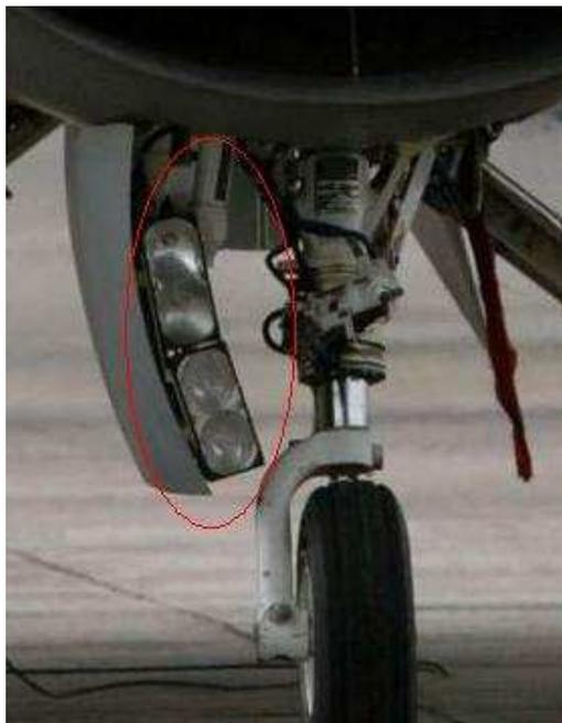
Un phare de roulage est situé sur la trappe de train droit pour éclairer le sol, entre autres de nuit. Les phares sont allumés par le bouton à 3 positions LANDING TAXI LIGHTS (figure 1-34) situé sur le panneau de contrôle LG. Le bouton a 3 positions : LANDING, OFF et TAXI. Le phare s'éteindra lors de la rétraction du LG si le bouton est laissé sur TAXI ou LANDING.
