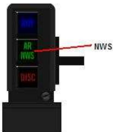
Le voyant NWS est l'élément central de l'indicateur de statut NWS AR situé sur la partie haute du tableau de bord (figure FO-15). Le voyant s'allume quand le NWS est engagé. Le NWS ne fonctionnera pas même si le voyant NWS est allumé quand le voyant d'avertissement est allumé ou quand la pression du système hydraulique B est indisponible. Au sol, le NWS continuera de fonctionner avec le bouton AIR REFUEL sur OPEN même si le voyant NWS est éteint.
