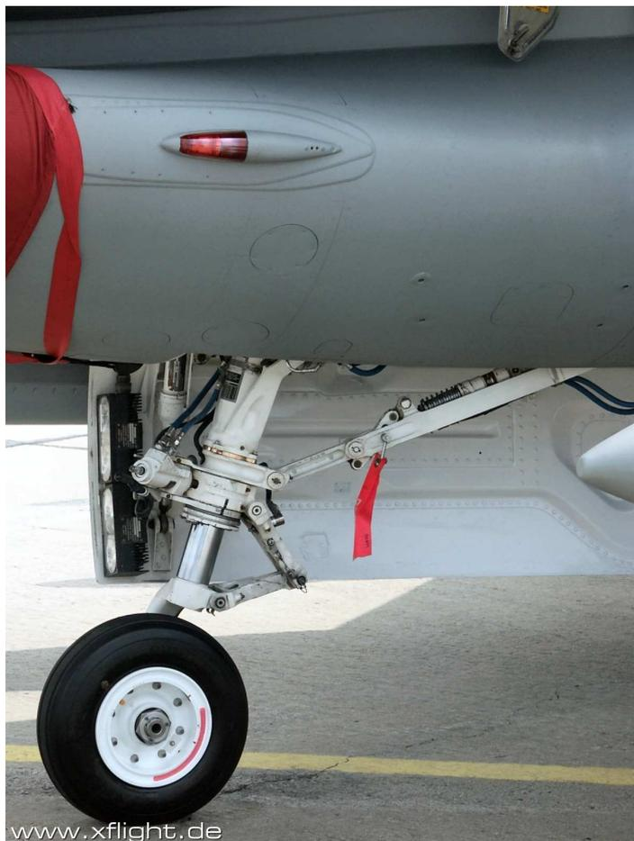
Le train avant se rétracte vers l'arrière de 90° avec une rotation de la roue vers l'intérieur. Une déconnection rapide sur la liaison ciseau est fournie pour que le la roulette de nez puisse tourner au-delà de la zone de conduite pour la rétraction.
