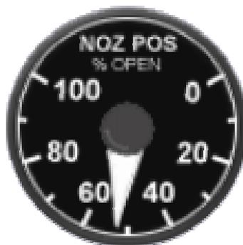
L'indicateur NOZ POS (figure 1-8) n'est pas un instrument à lecture directe mais affiche la zone de commande CENC de 0% (fermé) à 100% ouvert. L'indicateur est alimenté par l'emergency ac bus n°2.
