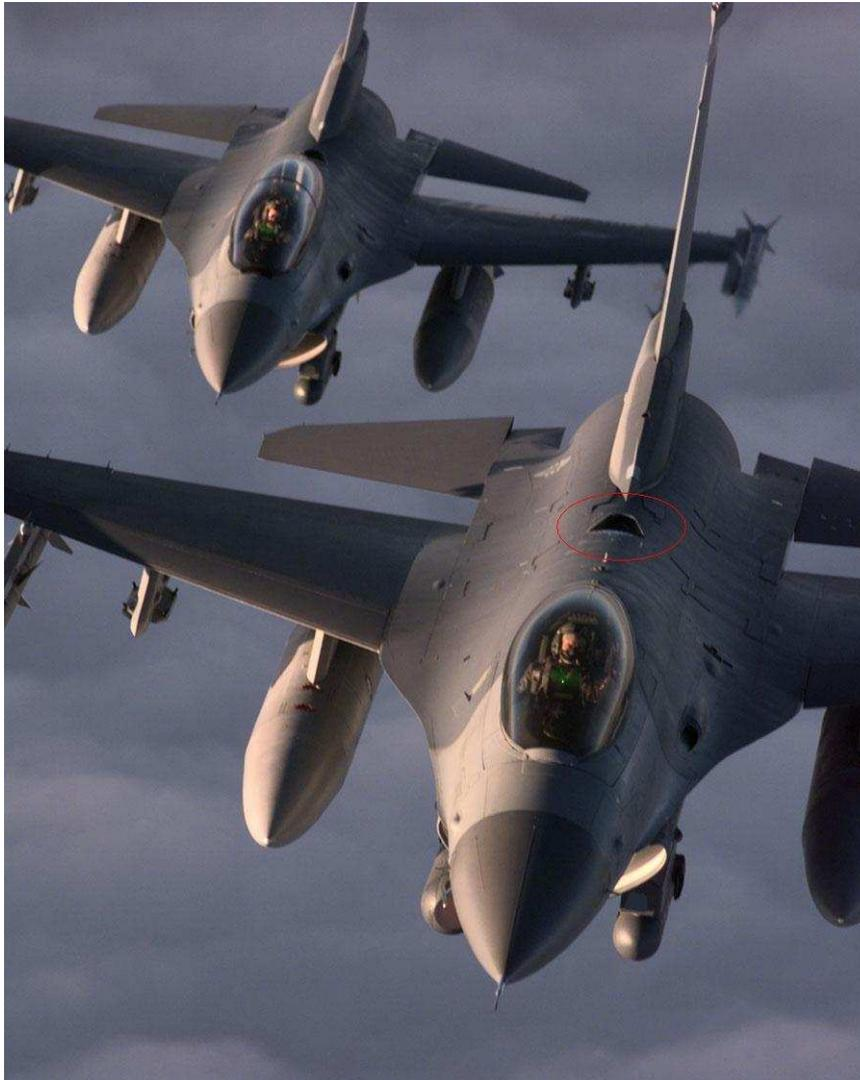
Le système AR comprend un réceptacle actionné hydrauliquement et une trappe coulissante, un amplificateur de signal et les indicateurs et contrôles associés. Le système hydraulique B fournit la pression pour l'utilisation de la trappe et le mécanisme de verrouillage. Le réceptacle est situé sur le dessus du fuselage derrière la verrière. Quand la trappe est ouverte, un mécanisme rétracte la trappe à l'intérieur du fuselage, laissant découvrir le réceptacle.
