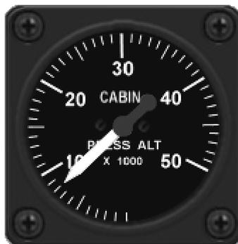
L'altimètre pression cockpit est situé sur la console auxiliaire droite et est mentionné comme CABIN PRESS ALT.
