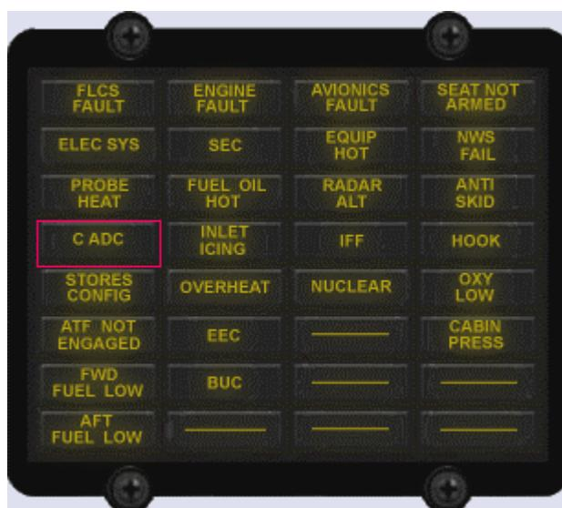
Le voyant d'alerte CADC s'allume quand un dysfonctionnement est détecté. Le voyant d'alerte EEC s'allumera également si le dysfonctionnement affecte le signal du nombre de Mach.
