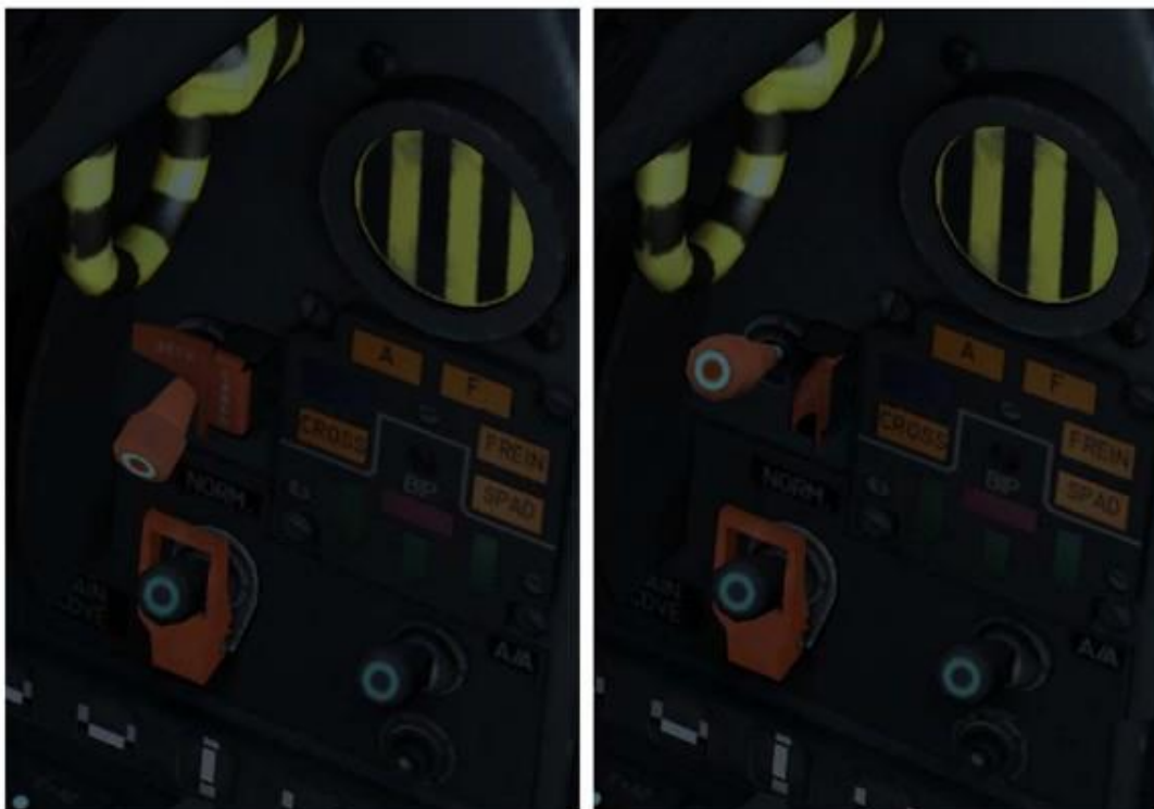
Figure 34Gun Interrupteur de bras dans les positions SAFE et ARMED
