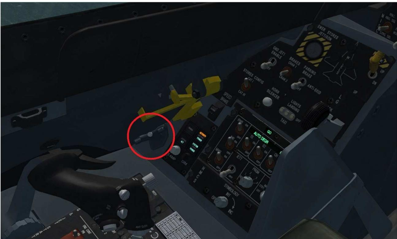
Si jamais vous récupérez le circuit hydraulique B par la suite, et souhaitez remonter le train, la poignée ALT GEAR comprend en son centre un petit bouton RESET qui permet de repasser en fonctionnement normal du train.
