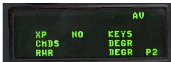
Le pilote appuie sur le bouton F-ACK. Le PFLD affiche alors la 2<sup>e</sup> page des pannes, d'où la mention « P2 » sur la droite de l'écran. Il n'y a pas de flèches : la 2<sup>e</sup> page est donc la dernière page de pannes. Si le pilote appuie encore sur le bouton F-ACK, il reviendra à un écran vierge de lignes de pannes, mais la mention « AV » restera affichée en haut à droite pour lui rappeler qu'il subsiste un problème d'avionique.
