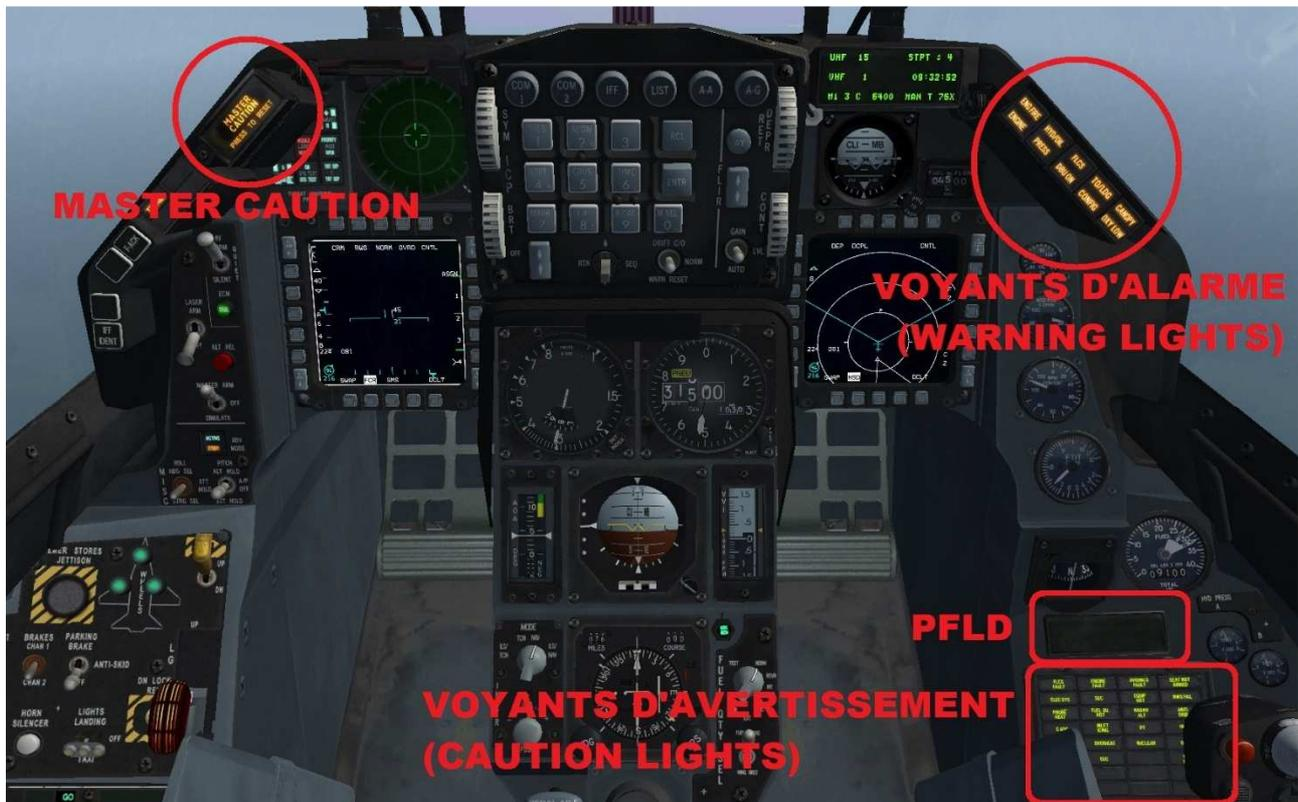
Le pilote est prévenu dans le cockpit de l'apparition de dysfonctionnements par des indications sonores (message ou sonnerie) et visuelles (message dans le HUD et voyants lumineux).
