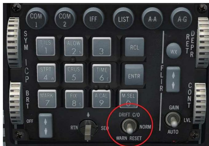
Le commutateur DRIFT C/O – WAR RESET de l'ICP, sous le collimateur.
