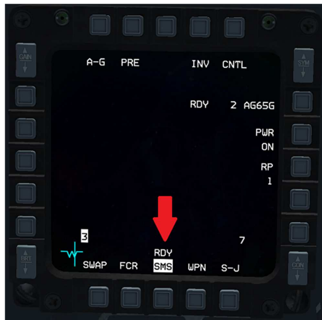
3 minutes plus tard, NOT TIMED OUT s'est effacé. RDY s'affiche au bas de l'écran. Les missiles sont à présent utilisables.
